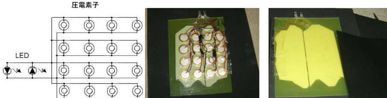
圧電素子16個の配線図と配線の様子(上段の左および中)、ウレタンとゴム板を張ったもの;完成図(上右、下中および右)
